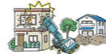
プレハブ住宅工事現場でアウトリガーの固定が不安定だったためクレーン車が転倒。隣家を損壊し、住人にケガをさせてしまった。
